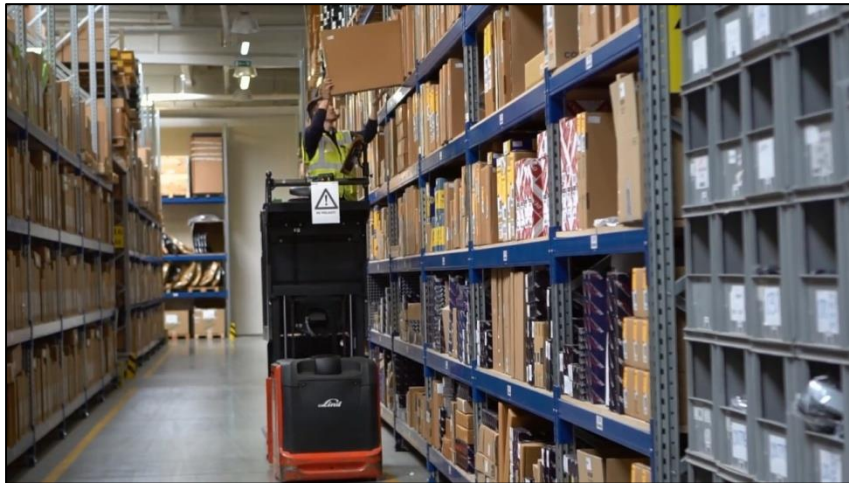
Slika 20. Komisioniranje uz pomoć prilagođenog električnog viličara
