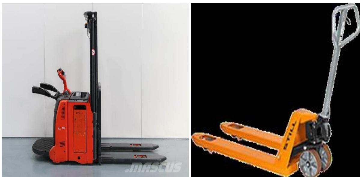
**Slika 12.** Prikaz paletnog viličara (slika lijevo) i ručnog viličara (slika desno)
