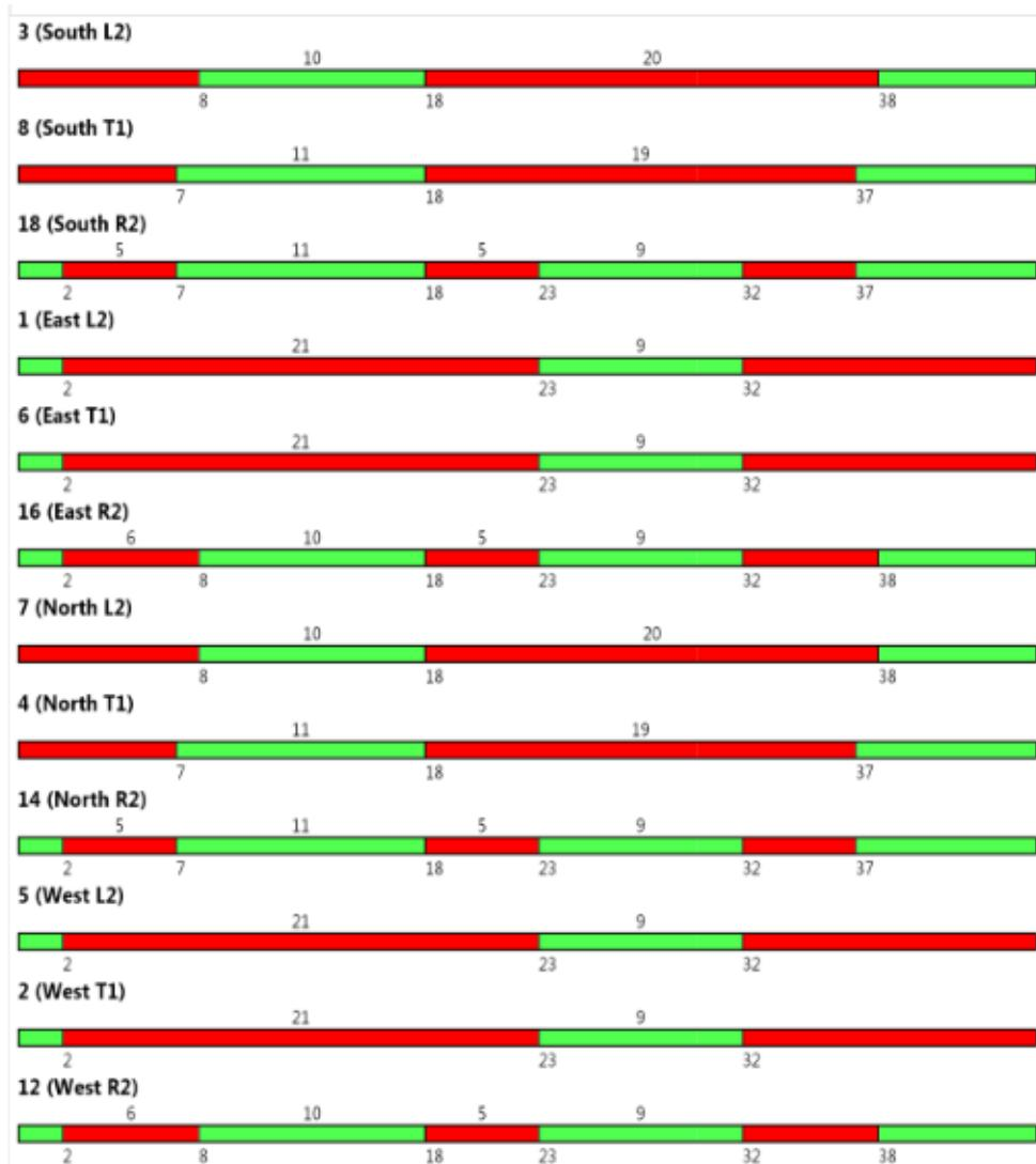
Slika 29. Optimalan signalni plan prema SIDRA-i INTERSECTION
