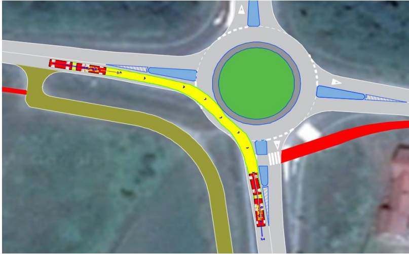
Slika 24. Provjera provoznosti za privoz 4 - desno
