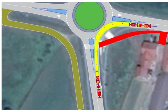
Slika 15. Provjera provoznosti za privoz 1 - desno
