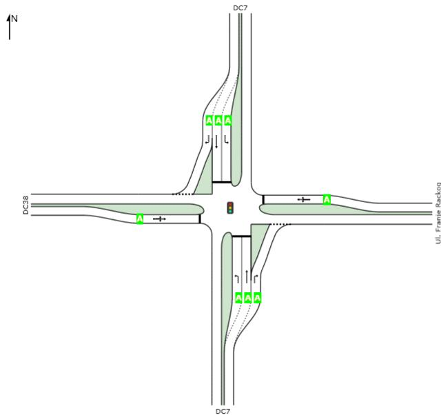
**Slika 28. Razina usluge za semaforizaciju prema SIDRA-i INTERSECTION**
