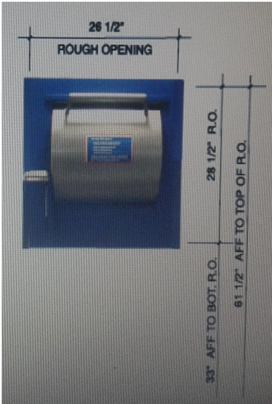
Slika 7. Spremnik za pošiljke i pakete ugrađen u zid, [19]
