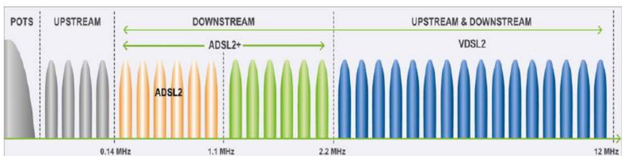
Slika 3. Usporedba frekvencijskog pojasa ADSL2, ADSL2+ i VDSL tehnologija, [10]
