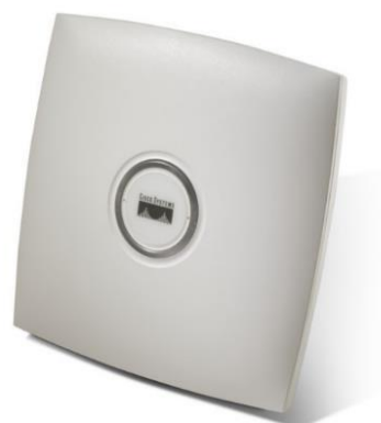
Slika 22 Pristupna točka korištena u postojećoj mreži Objekta 71 - Cisco Aironet 1130AG.
