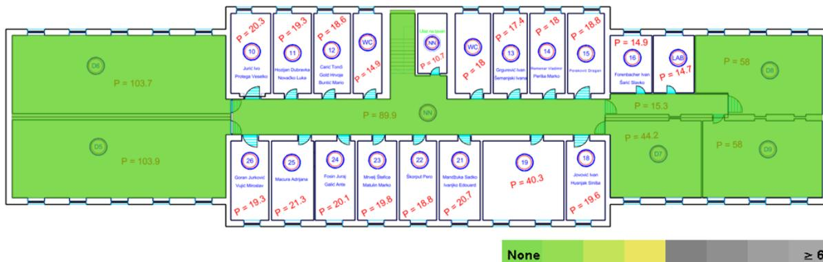
Slika 101 Preklapanje kanala u 5 GHz pojasu na katu.
