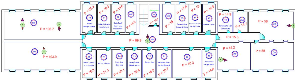
**Slika 109** Raspored pristupnih točaka na katu.
