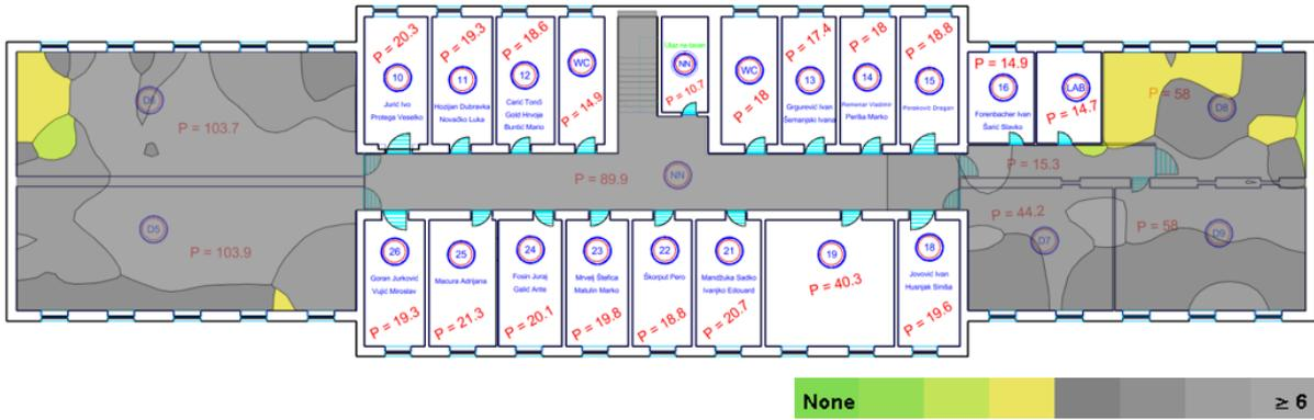
Slika 57 Preklapanje kanala u 2.4 GHz pojasu na katu.
