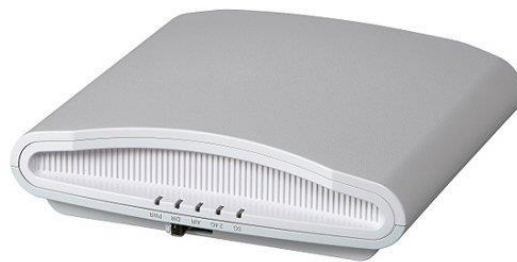
Slika 66 Pristupna točka korištena za prvu verziju prediktivnog modela mreže Objekta 71 - Ruckus ZoneFlex R710.
