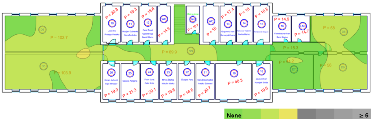
Slika 140 Preklapanje kanala u 2.4 GHz pojasu na katu.
