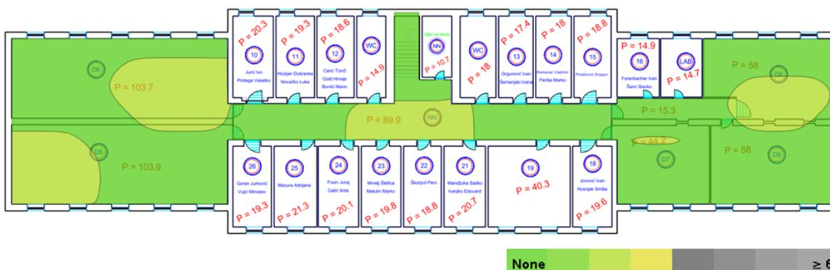
**Slika 167** Preklapanje kanala u 5 GHz pojasu na katu.
