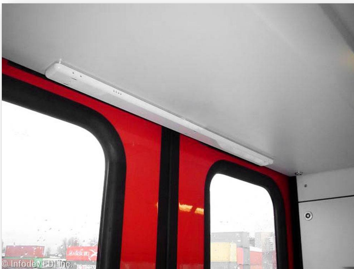
Slika 14. Položaj senzora i diskretno uklapanje u vozilu
