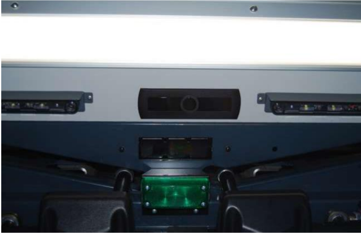
Slika 20. Irma Matrix senzor u YRT nova busu
