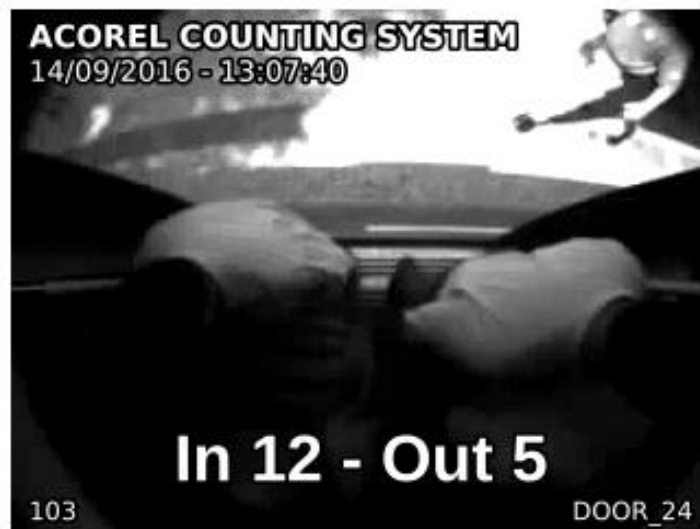
Slika 6. Prikaz brojanja stereoskopskim 3D senzorom
