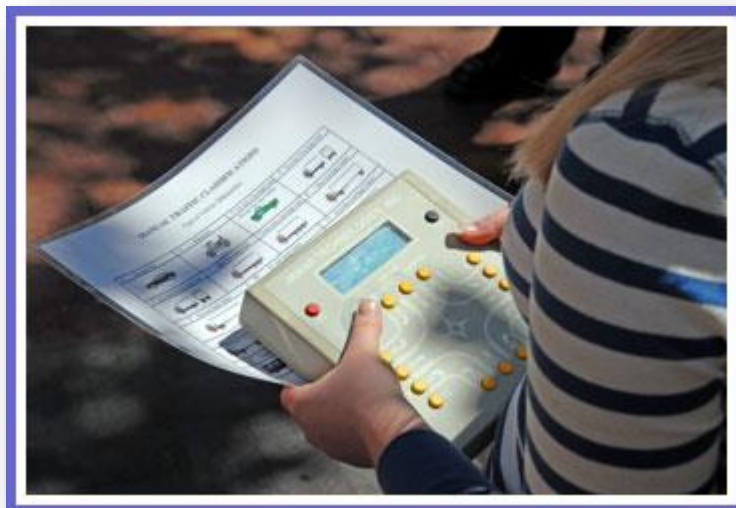
Slika 2. Primjer brojanja prometa sa električnim brojačem
