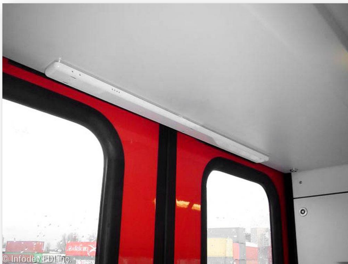
Slika 14. Položaj senzora i diskretno uklapanje u vozilu
