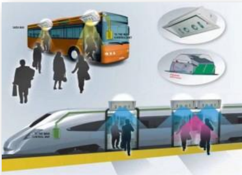
Slika 4. Primjer tehnologije brojača APC sustava
