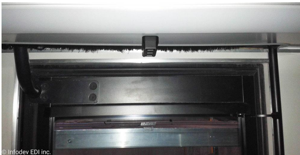
Slika 15. Senzor DA-200 u vozilu JGP-a
