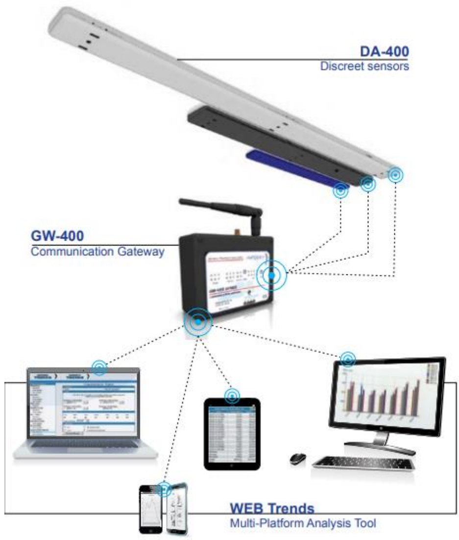
Slika 16. Slikovni prikaz redoslijeda slanja informacija APC sustava
