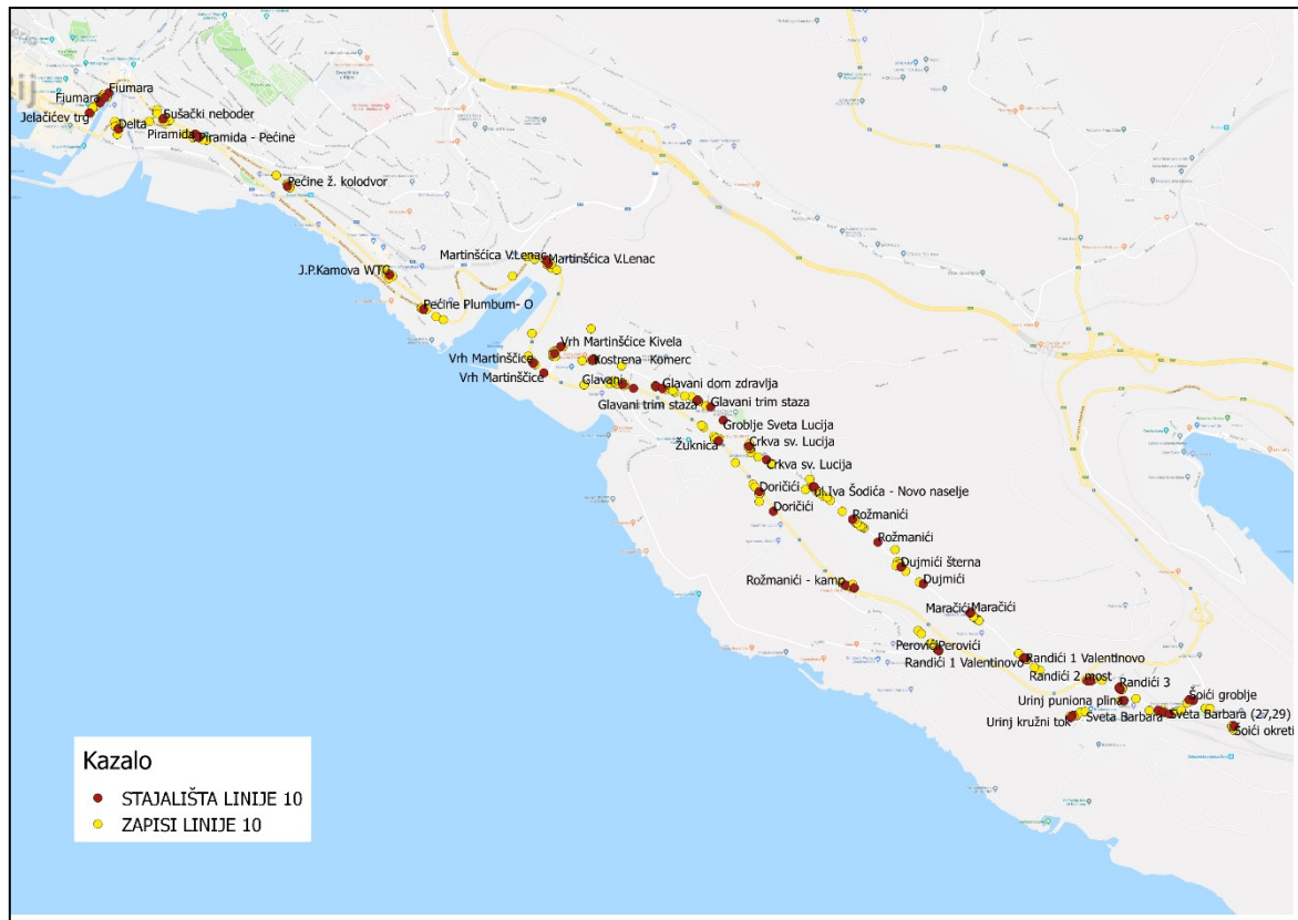
Slika 16. Sloj sa realnim koordinatama stajališta i pripadajućim nazivom (crveno) te ostale raspršene koordinate u odstupanju od točnosti, koje je potrebno svesti pod jednu lokaciju.
