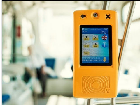
Slika 19. Validator za poništavanje beskontaktnih karata.
