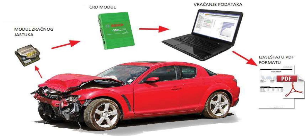
Slika 4. Shematski prikaz čitanja podataka iz EDR uređaja
