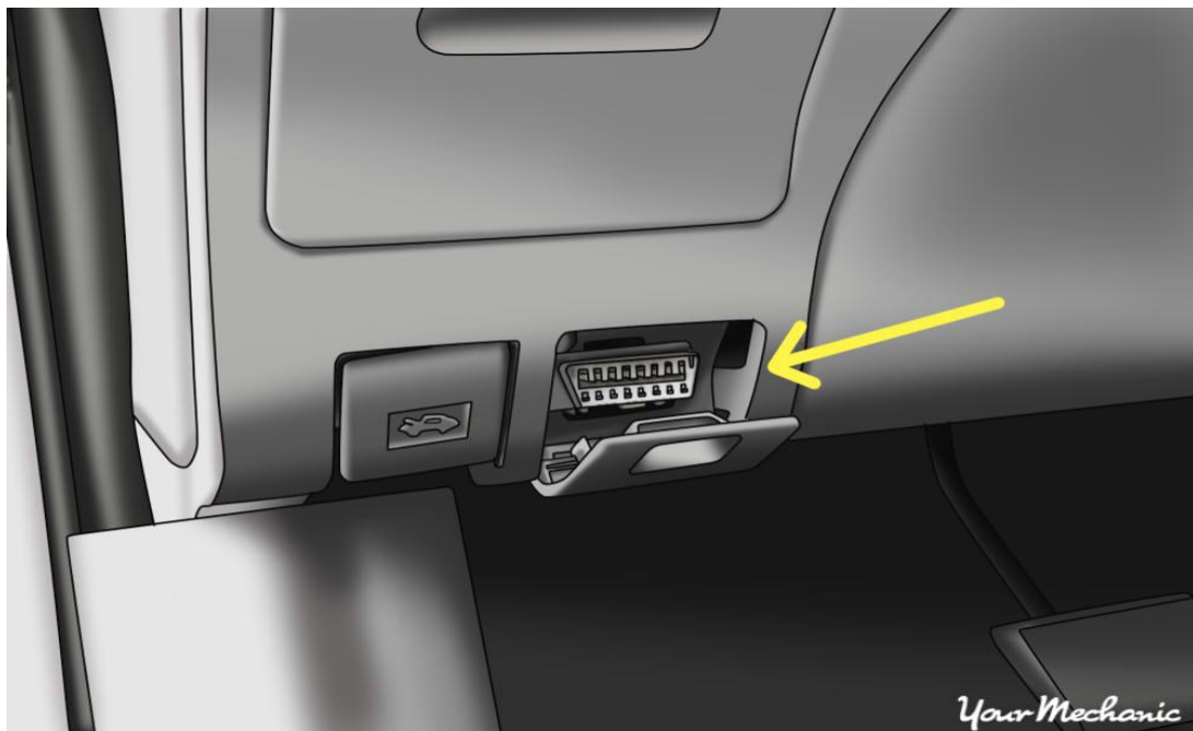
Slika 9. OBD priključak na vozilu
