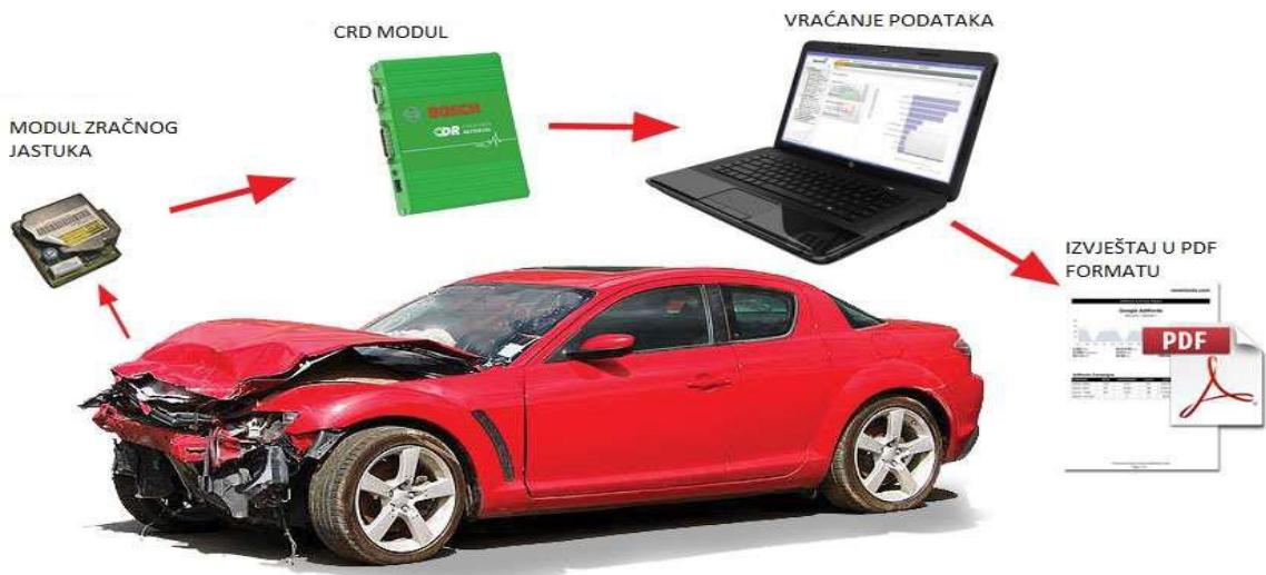
Slika 4. Shematski prikaz čitanja podataka iz EDR uređaja
