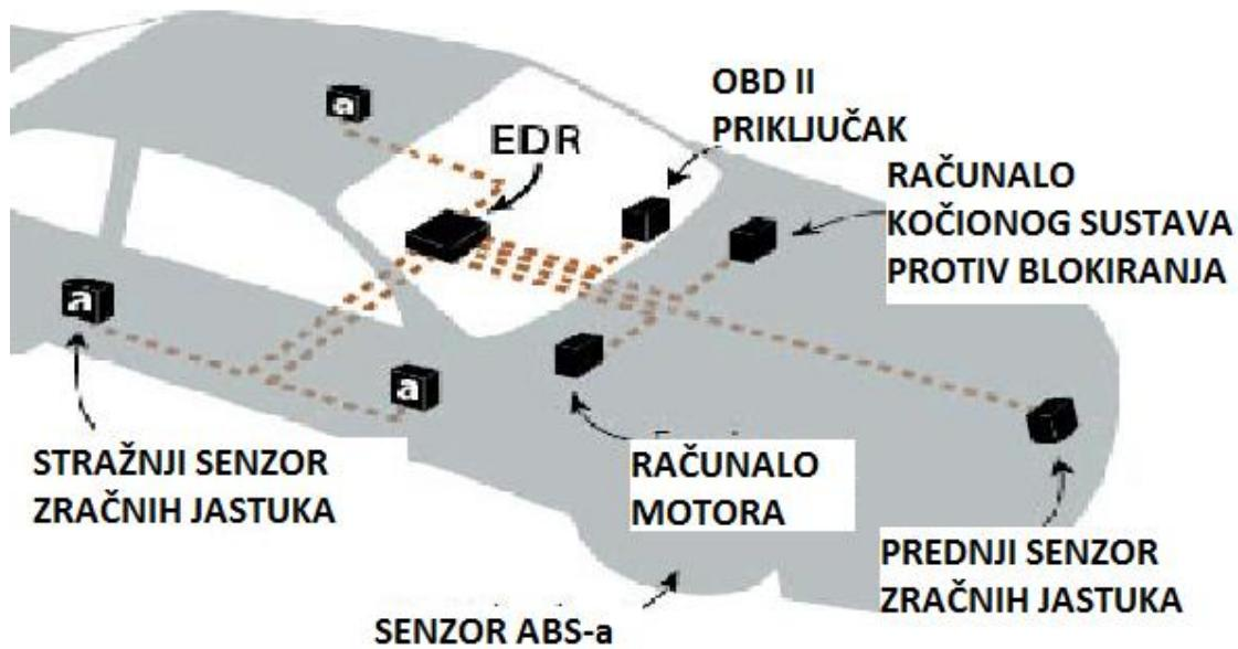
Slika 1. Shematski prikaz pozicije EDR uređaja i pripadajućih senzora
