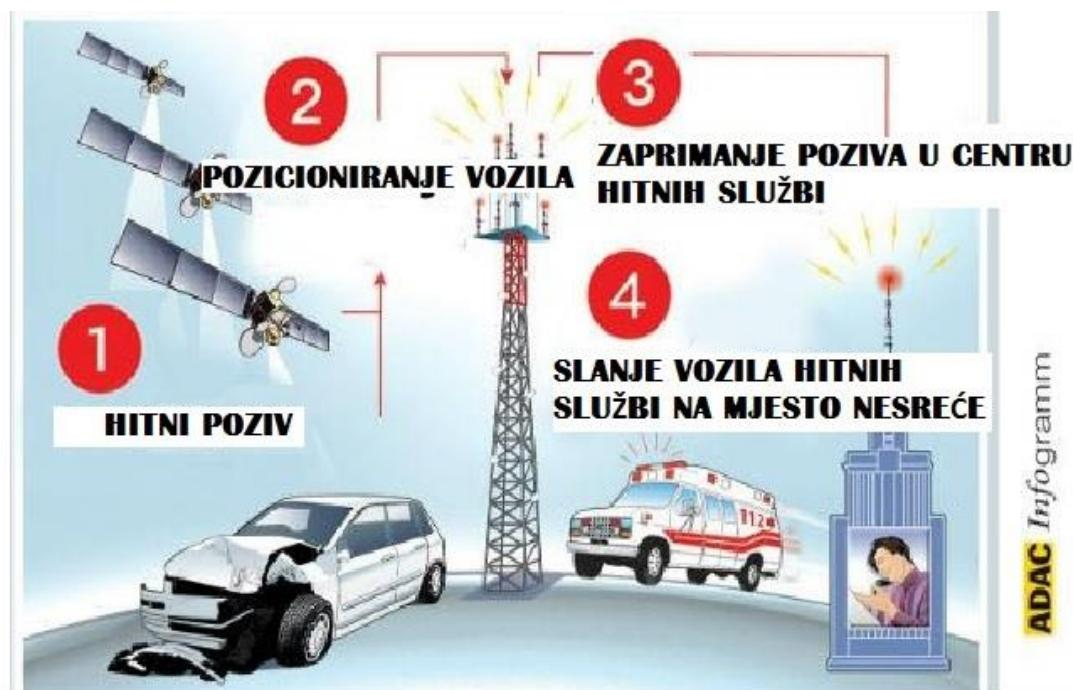
Slika 6. Shematski prikaz E – poziva
