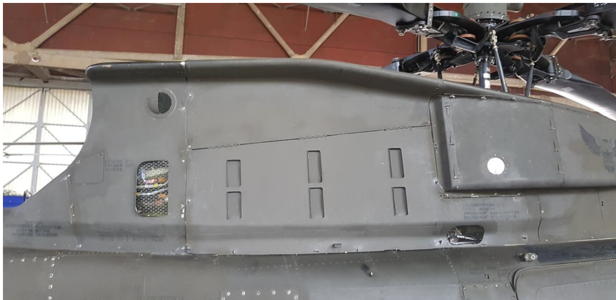
Slika 22. Kućište motora i ispušne cijevi helikoptera OH-58D
