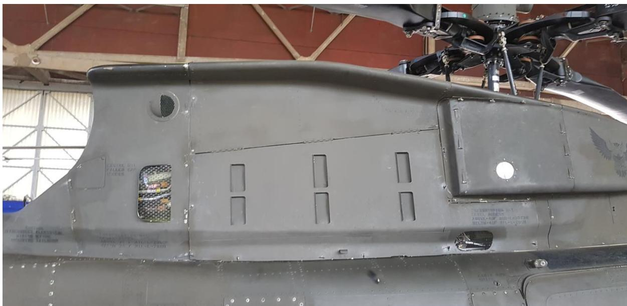
**Slika 22.** Kućište motora i ispušne cijevi helikoptera OH-58D
