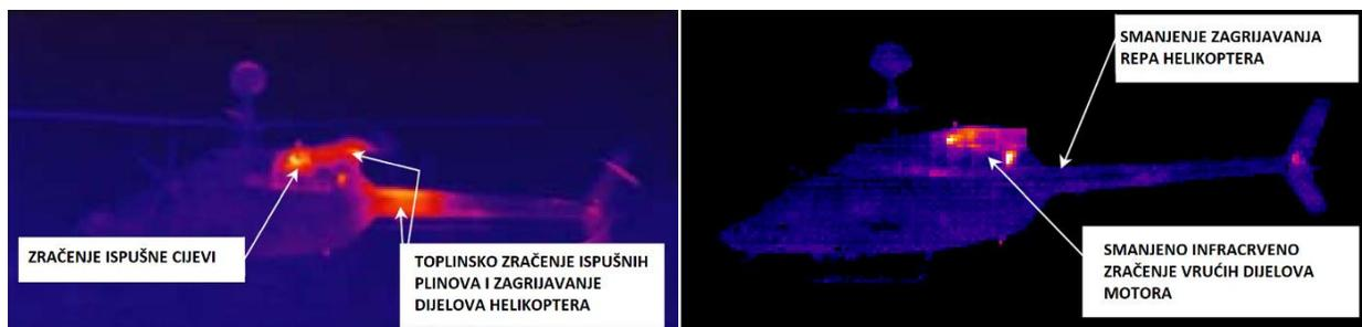
**Slika 20.** Usporedba toplinskih odraza helikoptera OH-58D prije i nakon preinake ispušne cijevi
