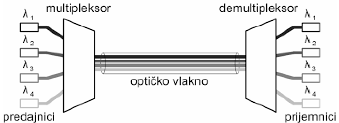
Slika 9 WDM sustav, preuzeto sa: https://goo.gl/YWeNPk (pristupljeno 31.08.2018.)
