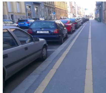
Slika 5.7. Dovoljan i nedovoljan zaštitni pojas od uzdužno parkiranih vozila
