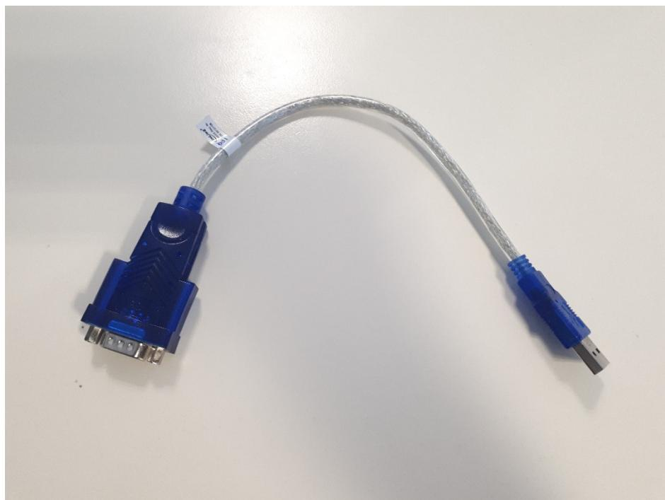
**Slika 6.13.** Adapter za konfiguraciju preklopnika
