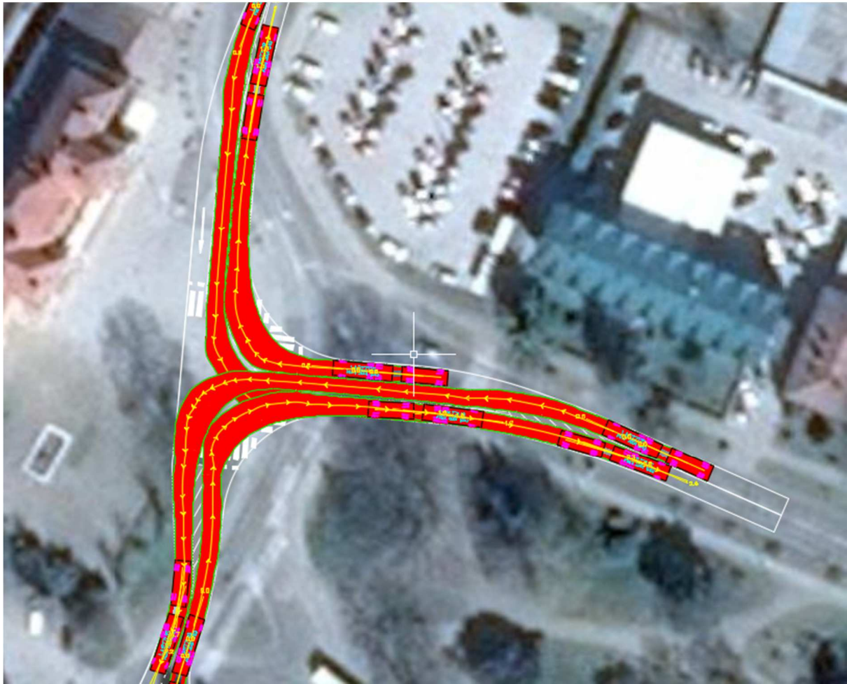
Slika 46. Trajektorije mjerodavnog vozila u programskom alatu AutoTURN za raskrižje Kolodvorske ulice i Ulice Ivana Meštrovića
