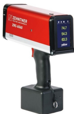
Slika 14. Uređaj za mjerenje retrorefleksije Zehntner ZRS 6060
