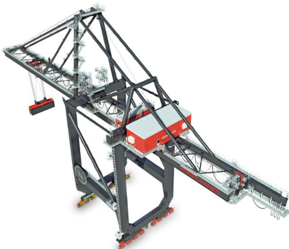
Slika 7. Obalna kontejnerska dizalica
