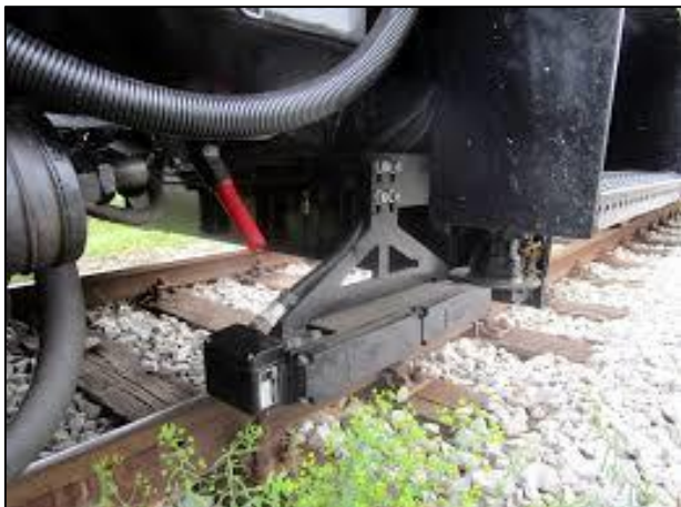
Slika 23. Ugrađena lokomotivska baliza na vozilu [autor]
