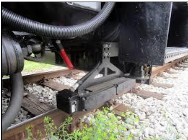
Slika 23. Ugrađena lokomotivska baliza na vozilu [autor]
