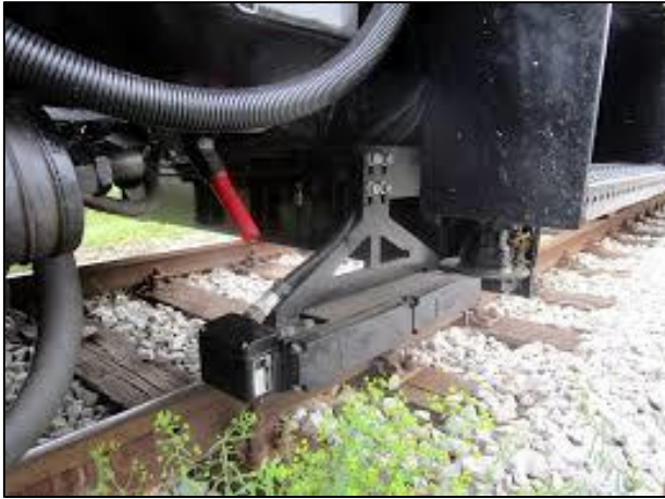
Slika 23. Ugrađena lokomotivska baliza na vozilu [autor]
