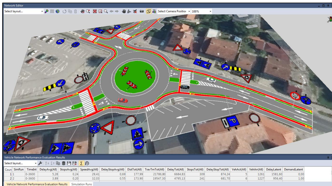
Slika 37. Prikaz simulacijskog modela prijedloga rješenja u programskom alatu PTV Vissim za raskrižje Sisačka ulica – Trg kralja Tomislava – Trg kralja Petra Krešimira IV.
