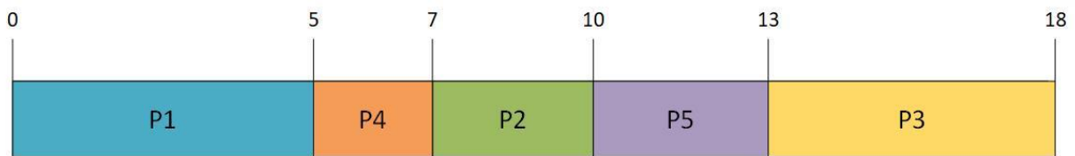
Slika 33. Prikaz redoslijeda posluživanja paketa metodom SPT
