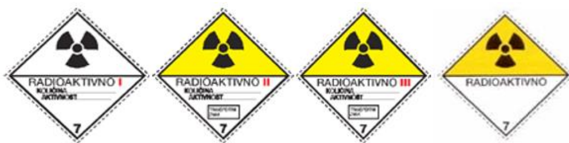
Slika 11.: Listice opasnosti za vozilo koje prevozi robu iz klase 7.
