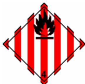
**Slika 4.:** Listica opasnosti za vozilo koje prevozi zapaljive krute tekućine
