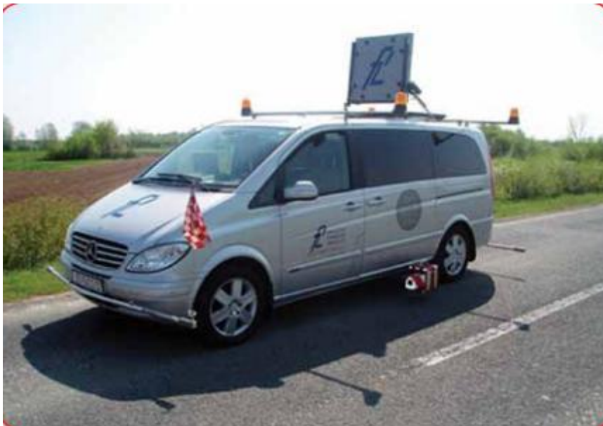
Slika 24: Uređaj za ispitivanje retrorefleksije oznaka na kolniku ZDR 6020
