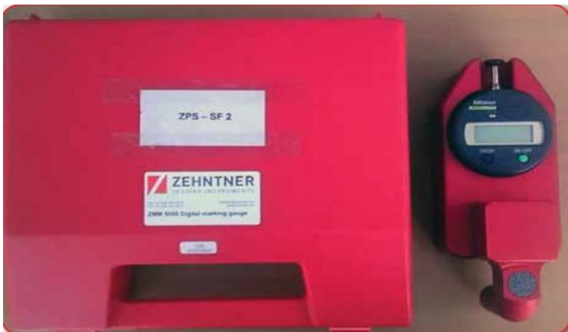
Slika 28: Uređaj za mjerenje debljine suhog filma boje
