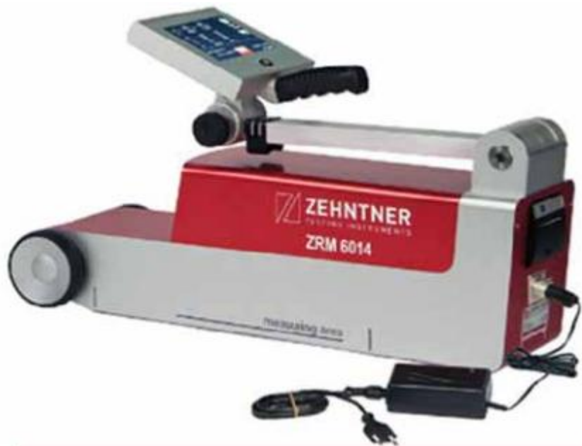
Slika 25: Uređaj za ispitivanje kvalitete oznaka na kolniku ZMR 6014
