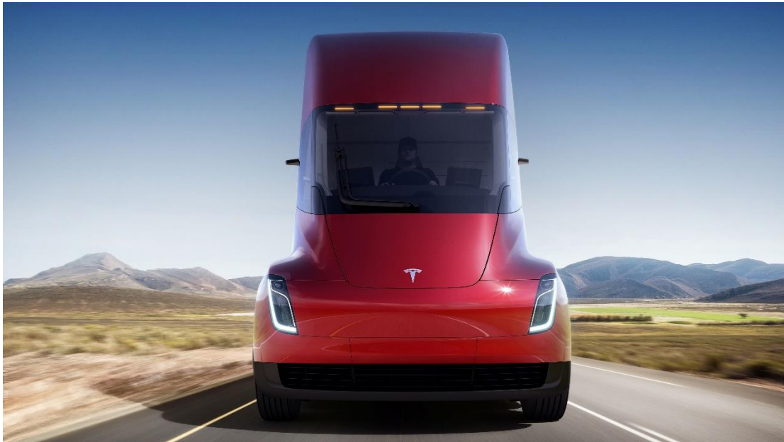
Slika 21. Tesla Semi bez retrovizora
