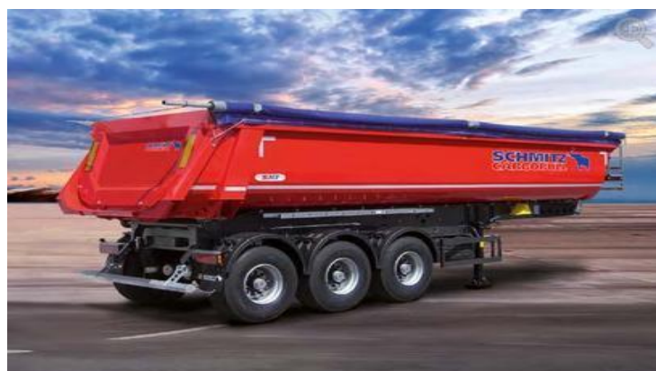
Slika 12: Primjer poluprikolice s otvorenim sandukom i bočnim stranicama
