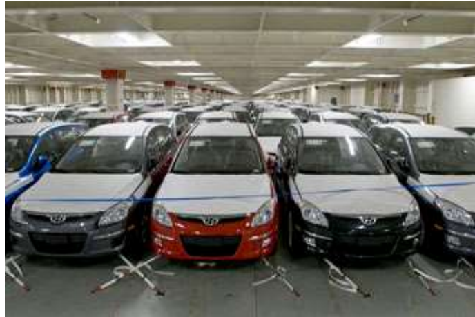
Slika 13. Učvršćivanje vozila na RO – RO brodovima
