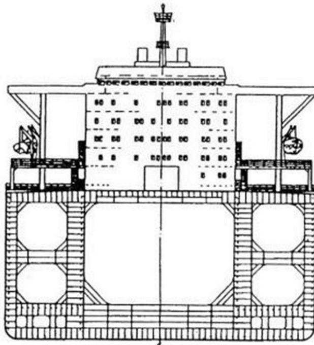
Slika 19. Poprečni presjek tankera
