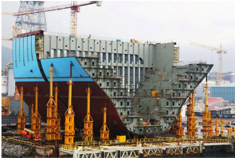
Slika 16. Konstrukcija trupa kontejnerskog broda
