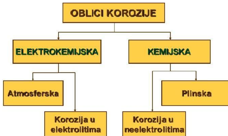
Slika 3.2. Shematski prikaz oblika korozije, [4]
