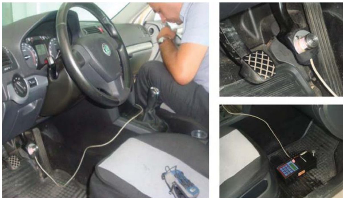
Slika 31. Postavljanje dinamometra i decelerometra u vozilo
