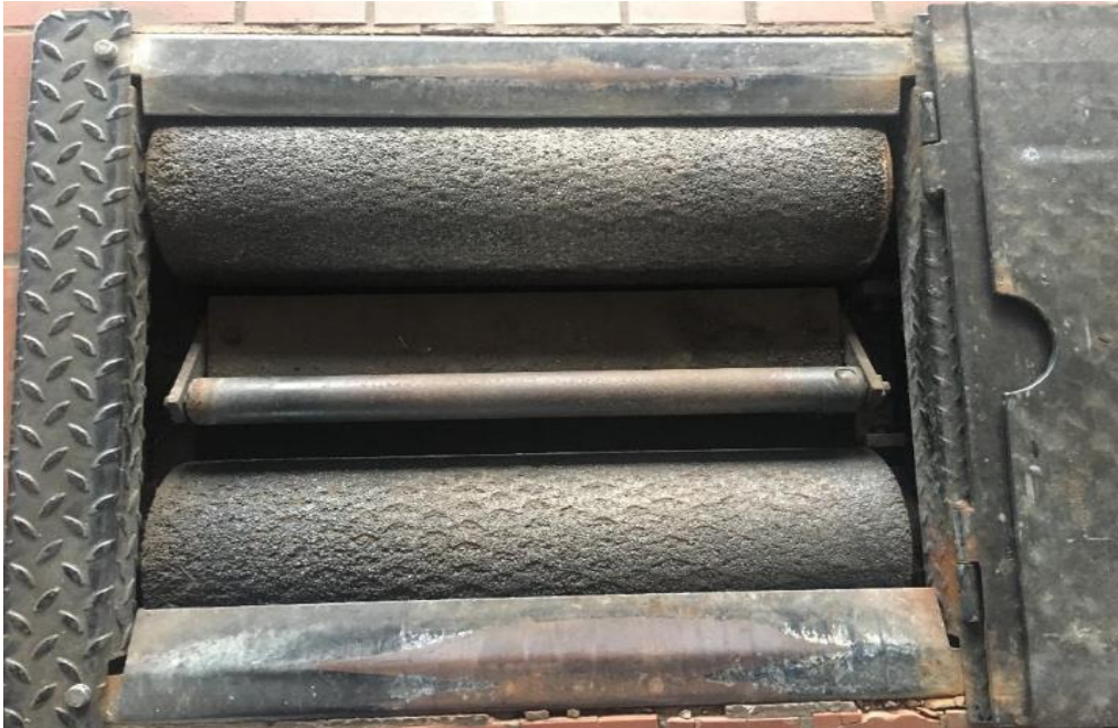
Slika 22. Valjci za ispitivanje kočnica
