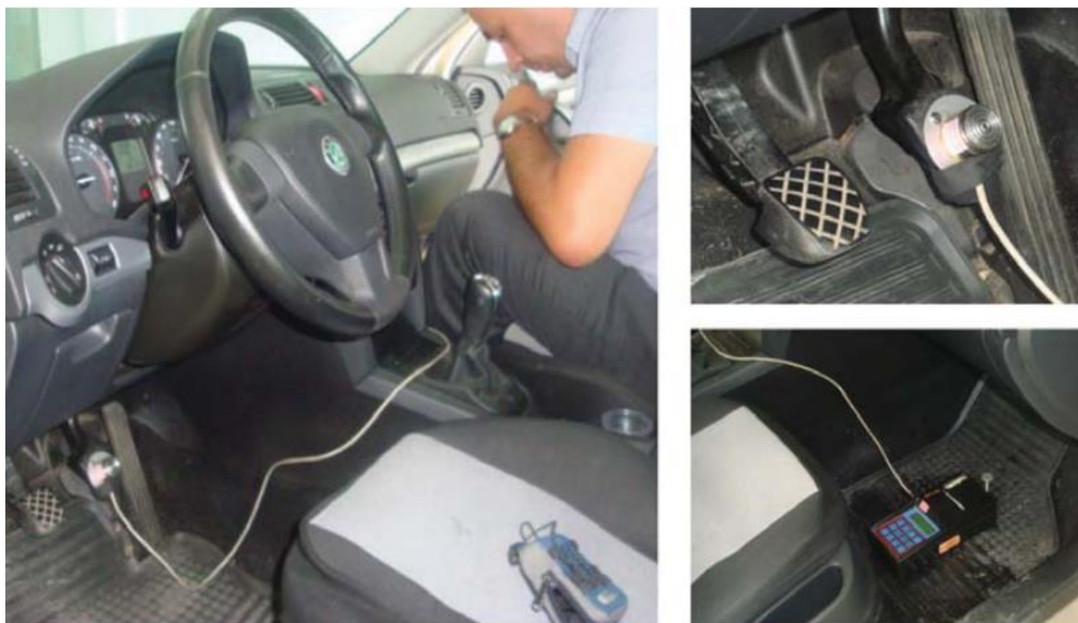
Slika 31. Postavljanje dinamometra i decelerometra u vozilo
