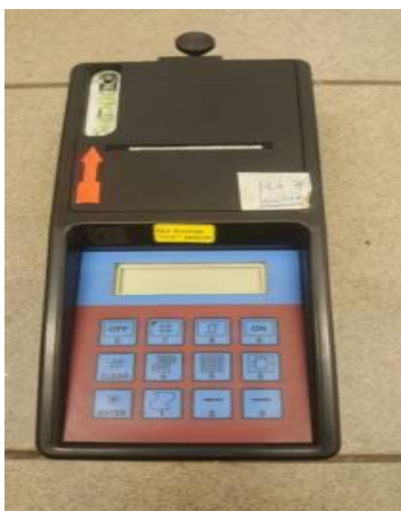
Slika 30. Mjerač usporenja (decelerometar) MAHA VZM 100
