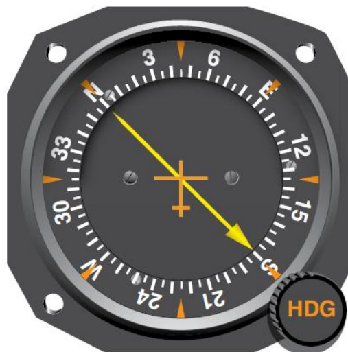
Slika 10. Pokazivač smjera NDB-a u zrakoplovu
