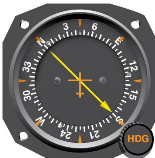
Slika 10. Pokazivač smjera NDB-a u zrakoplovu
