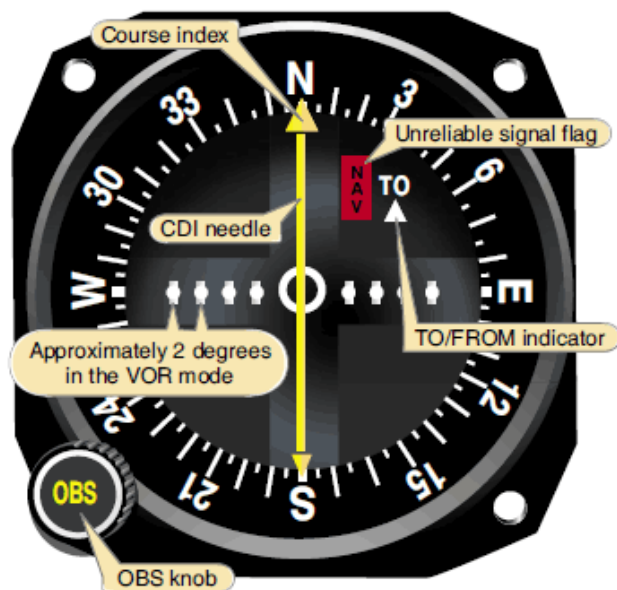
Slika 13. Pokazivač VOR-a u zrakoplovu
