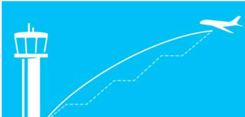
Slika 20. Operacija kontinuiranog spuštanja
