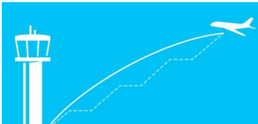
Slika 20. Operacija kontinuiranog spuštanja
