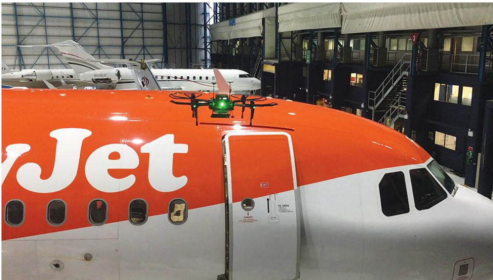
Slika 19. Dron Rapid u inspekciji EasyJet-ovog Airbusa A320
