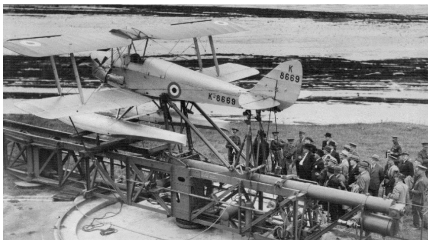
Slika 2. Bespilotna letjelica DH82B Queen Bee na lansirnoj rampi
