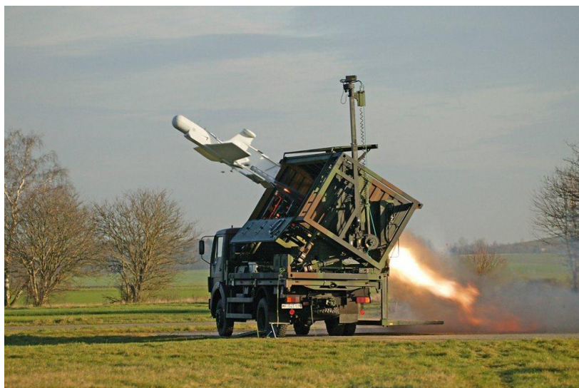
Slika 12. Bespilotna letjelica KZO s lansirnom rampom
