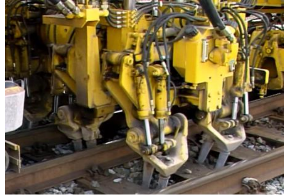
Slika 7. Podbijački agregat podbijačice [6]
