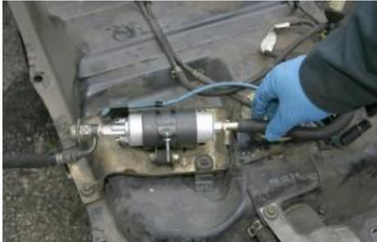
Slika 12. Pumpa goriva izvan spremnika
