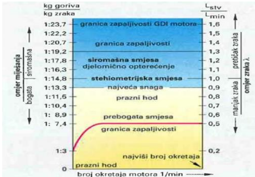
Slika 2. Stvarni omjer goriva i zraka
