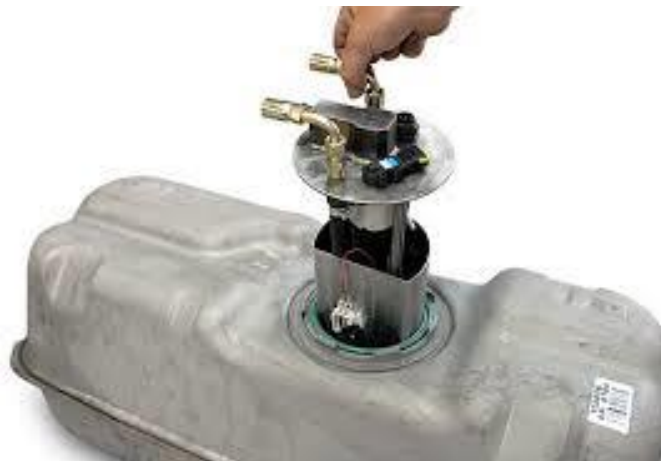
Slika 13. Pumpa goriva uronjena u spremnik
