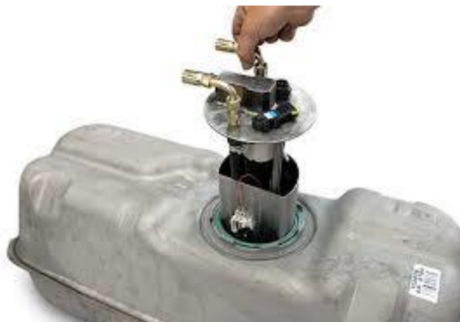
Slika 13. Pumpa goriva uronjena u spremnik
