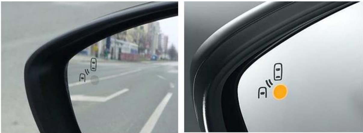
Slika 4: Indikator mrtvog kuta; Izvor: [8]
