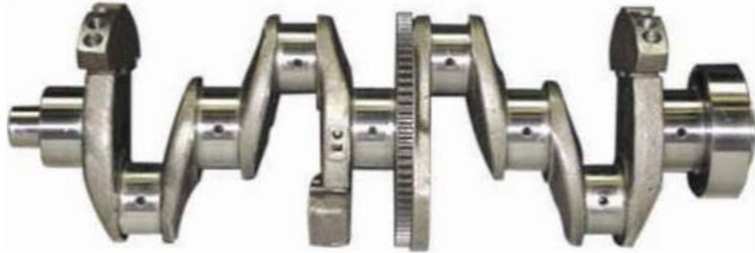
Slika 11. Koljenasto vratilo (tzv. radilica), [7].
