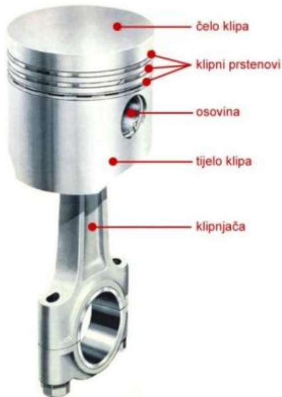
Slika 13. Klip, klipnjača, osovina i klipni prsteni, [8].
