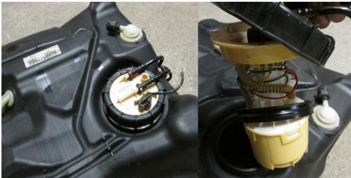
Slika 20. Pumpa za gorivo uronjena u spremnik goriva, [21].
