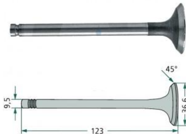
Slika 14. Ventil Otto motora, [14].
