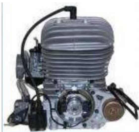
Slika 17. Prikaz motora sa prirodnom cirkulacijom zraka
