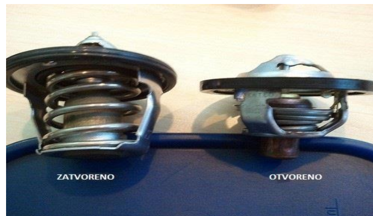
Slika 22. Prikaz zatvorenog (lijevo) i otvorenog (desno) termostata
