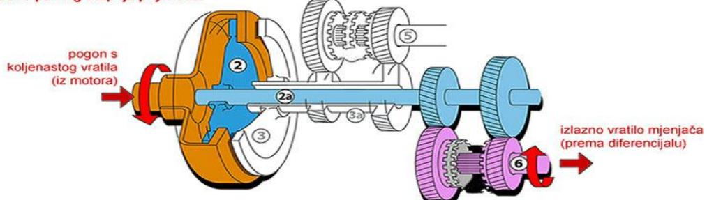
Lamela spojke parnih stupnjeva (2) je povezana s pogonom iz motora i pokreće ulaznu osovinu mjenjača (2a). moment se prenosi prema diferencijalu (i potom kotačima) putem zupčanika odabranog stupnja prijenosa na izlaznu osovinu mjenjača (6)
