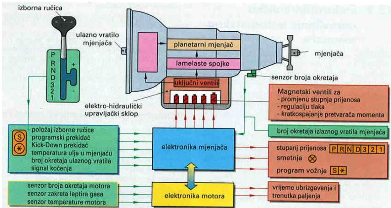
Slika 18. Shematski prikaz elektrohidrauličkog upravljanja mjenjačem [1]
