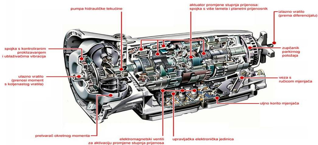
Slika 15. Automatski mjenjač sa 7 stupnjeva prijenosa [22]
