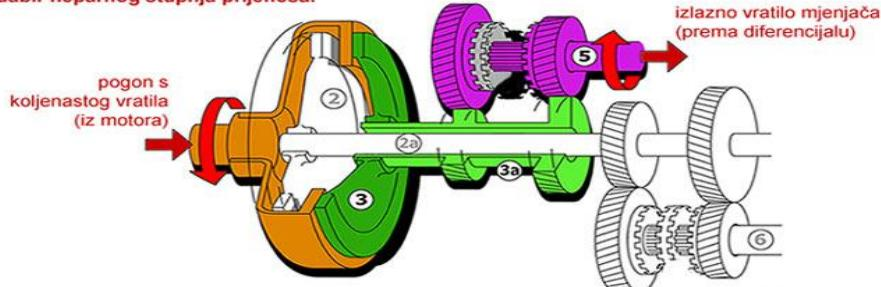
Lamela spojke neparnih stupnjeva (3) je povezana s pogonom iz motora i pokreće ulaznu osovinu mjenjača (3a). moment se prenosi prema diferencijalu (i potom kotačima) putem zupčanika odabranog stupnja prijenosa na izlaznu osovinu mjenjača (5)
