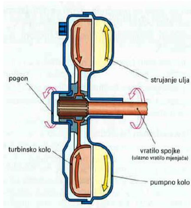
Slika 4. Hidrodinamička spojka [1]
