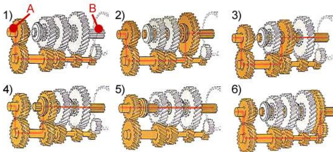
Slika 12. Postavke zupčanika ovisno o odabranom stupnju prijenosa [4]
