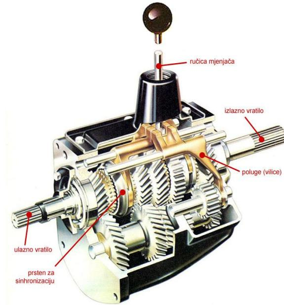
Slika 6. Ručni mjenjač s 4 stupnja prijenosa [4]
