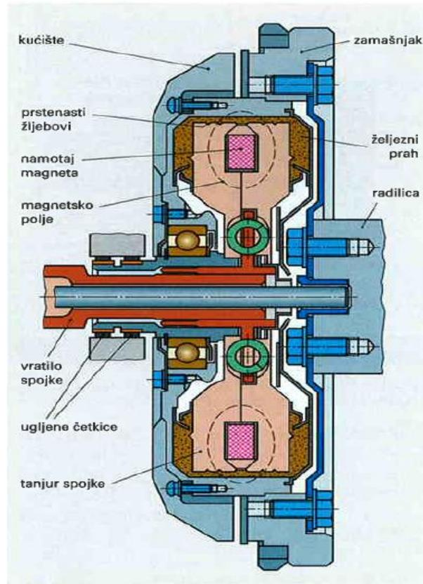
Slika 5. Elektromagnetska spojka [1]
