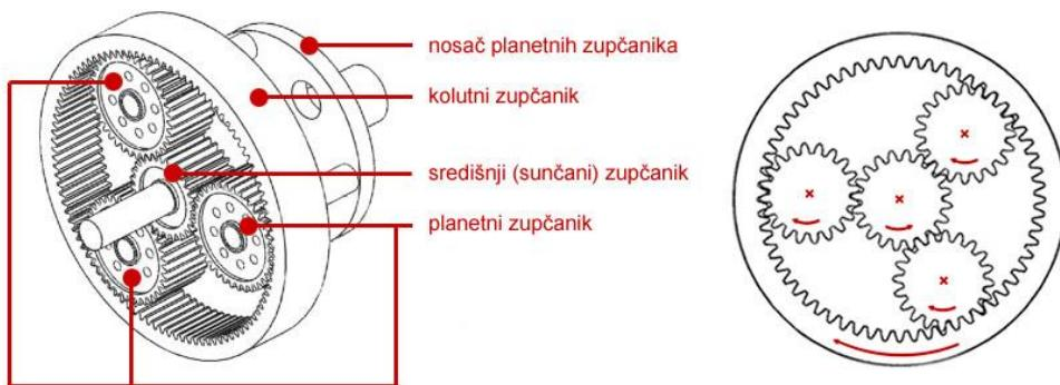
Slika 17. Planetarni prijenosnik i smjer vrtnje pojedinih zupčanika [22]
