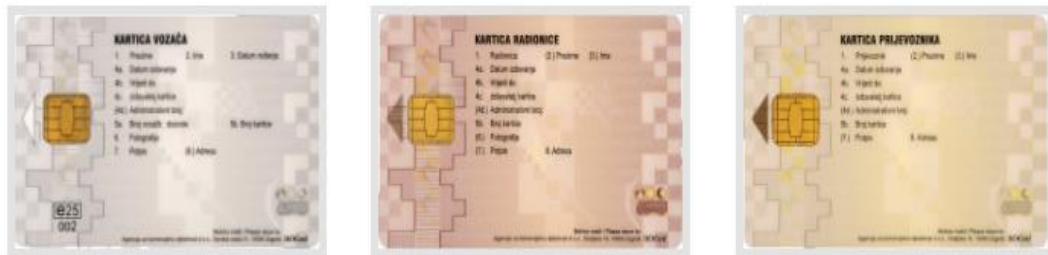
Slika 25: Tri vrste kartica digitalnog tahografa
