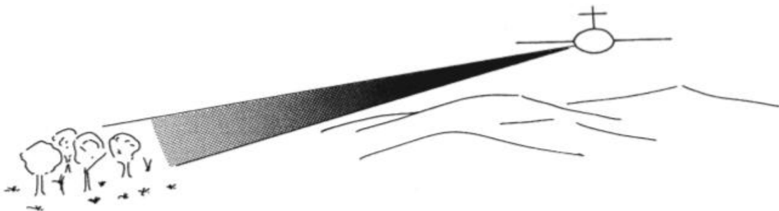
Slika 9. Zračenje napušta zrakoplov, odbija se i vraća natrag prema senzoru [1]
