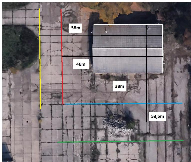
Slika 32. Udaljenosti pravaca snimanja objekta za dobivanje horizontalnih dimenzija
