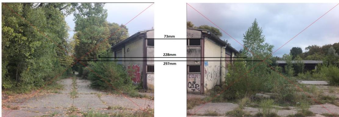
**Slika 33. Mjerenje duljine zgrade primjenom stereoskopske paralakse na fotografijama dobivenim horizontalnim snimanjem**
