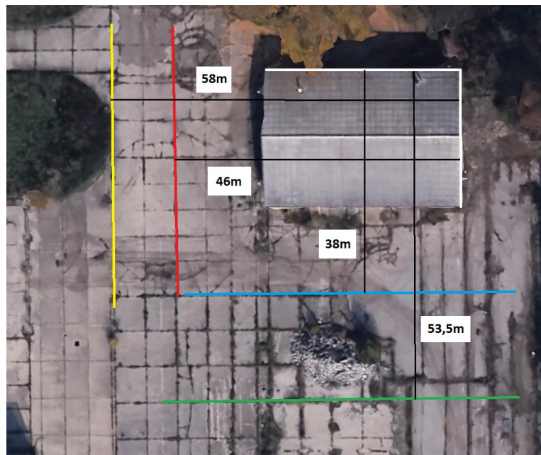
Slika 32. Udaljenosti pravaca snimanja objekta za dobivanje horizontalnih dimanzija
