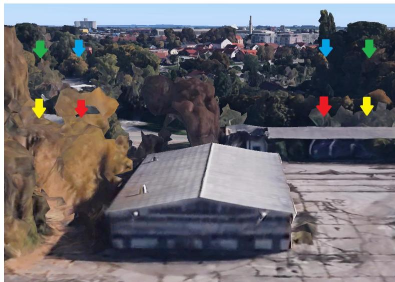
Slika 28. Planirani parovi vertikalnog snimanja
