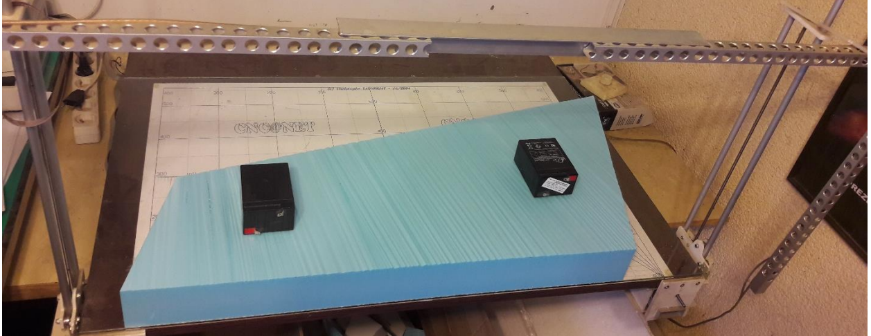
Slika 21 Dio procesa rezanja materijala AVIO-rezom
