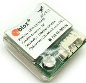
Slika 12 Neke od izvedbi GPS-a za bespilotne letjelice [20]
