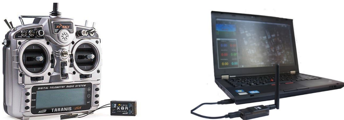
Slika 15 Upravljačka [23] i zemaljska stanica [24] bespilotne letjelice
