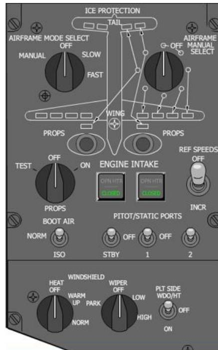
Slika 5: Upravljačka ploča za zaštitu od zaleđivanja [12]
