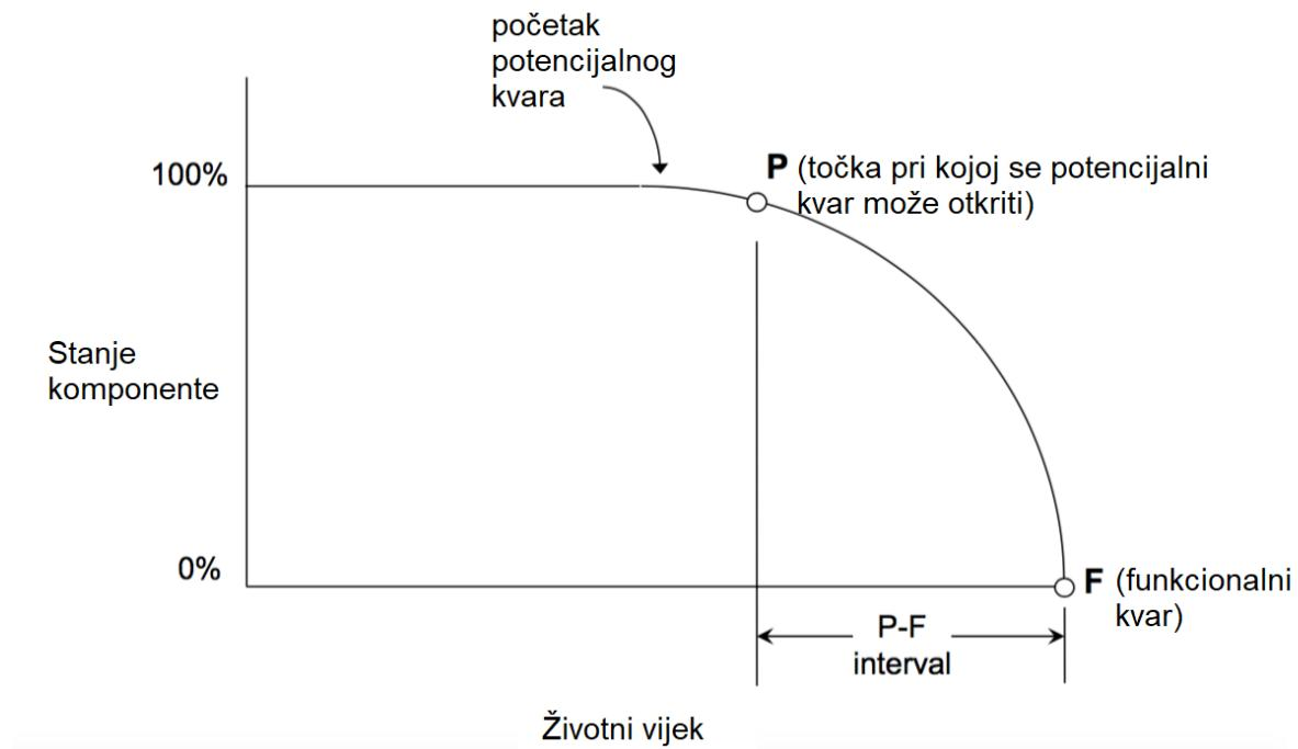
Slika 16: Životni vijek i točka potencijalnog neuspjeha – P, pri kojoj potencijalni kvar postaje uočljiv
