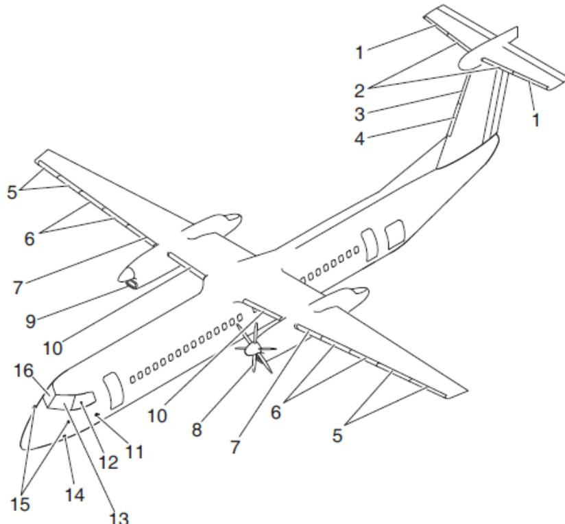
Slika 6: Sustavi zaštite od kiše i leda na zrakoplovu Dash 8 - Q400 [13]
