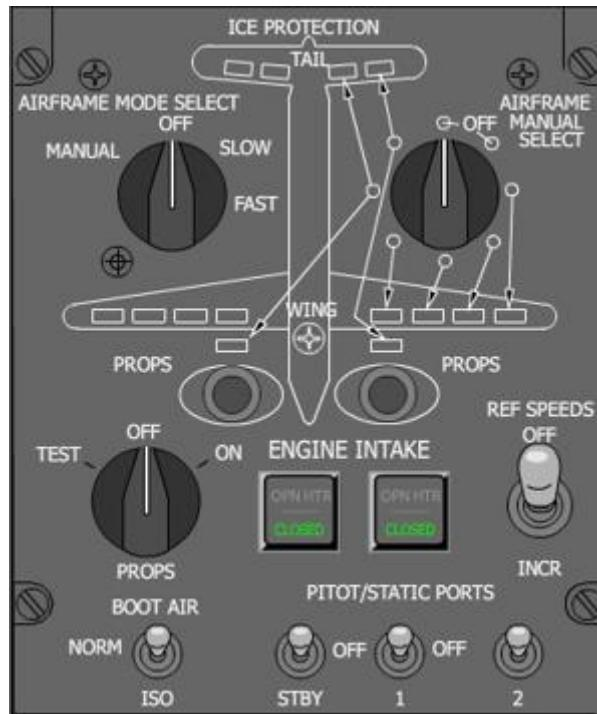
Slika 12: "BOOT AIR - ISO" prekidač na upravljačkoj ploči za zaštitu od zaledivanja [12]
