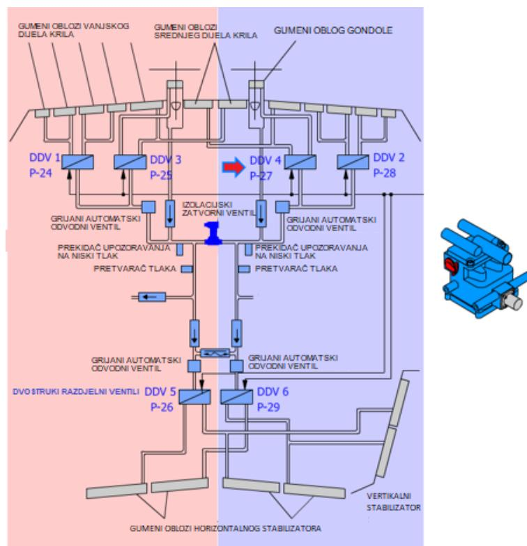
Slika 7: Izgled i smještaj dvostrukog razdjelnog ventila [12]
