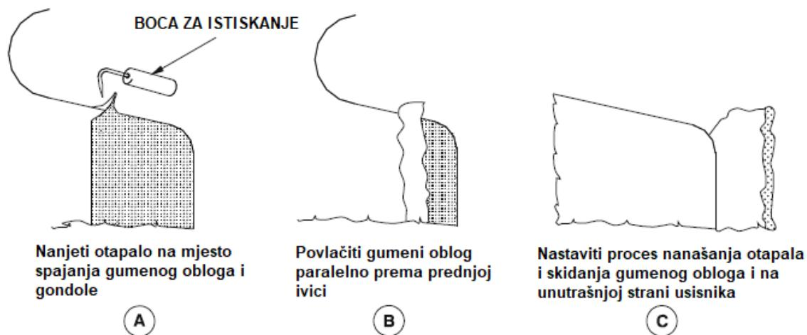
Slika 14: Pojednostavljeni prikaz procesa uklanjanja gumenih obloga [14]
