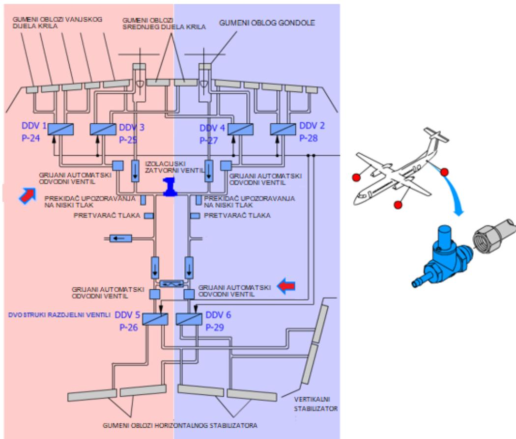
Slika 8: Izgled i smještaj automatskih odvodnih ventila [12]
