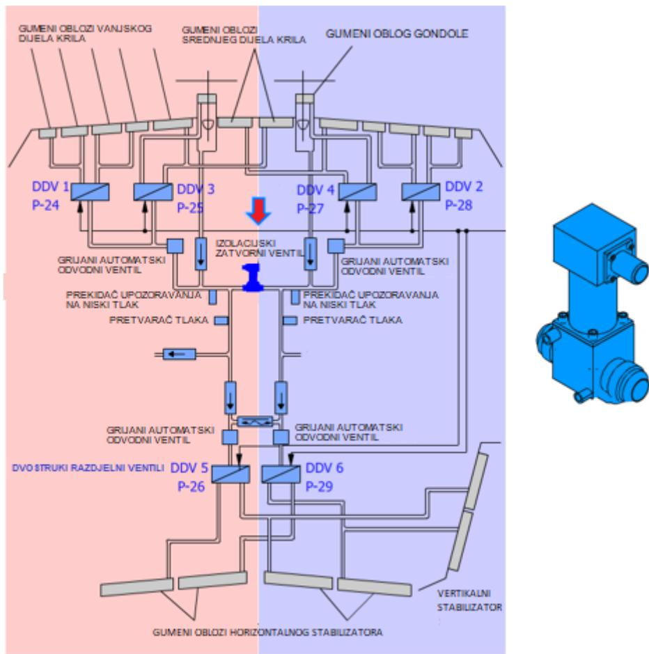
Slika 13: Smještaj i izgled izolacijskog zatvornog ventila [12]
